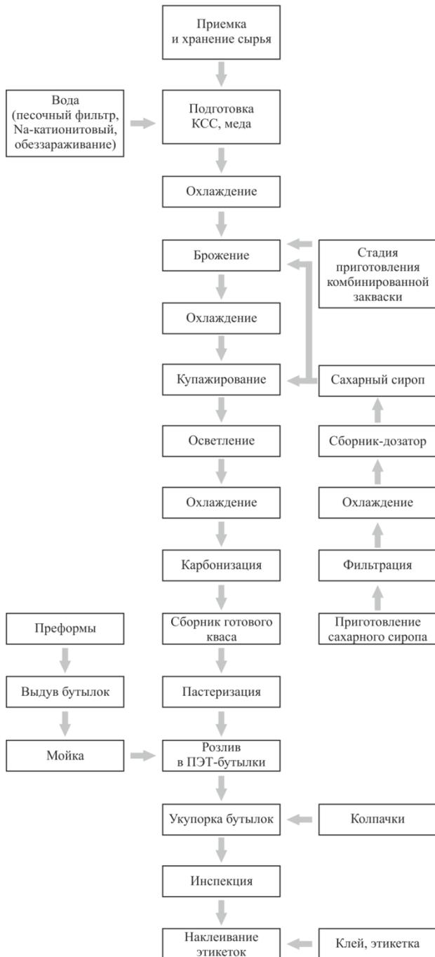
Рис. Схема технологического процесса производства кваса
