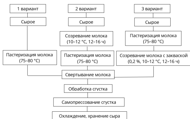
Рисунок. Технологическая схема различных вариантов производства мягких сыров [19]
