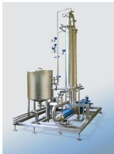
Рис. 1. Экспериментальная фильтрационная установка МФС-2x3M41
