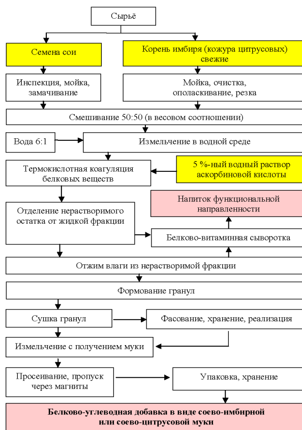
Рис. 9. Технологическая схема безотходного производства белково-углеводной добавки в виде соево-имбирной и соево-цитрусовой муки
