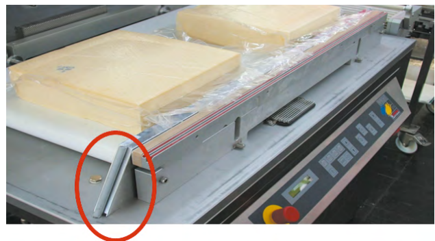
Рисунок 2. Камерный упаковщик с делительной планкой (отмечена красным эллипсом)
