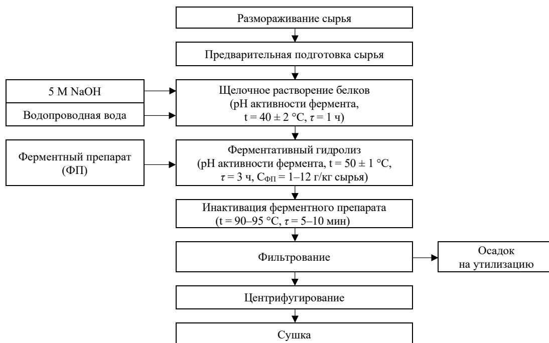
Рисунок 1. Технологическая схема получения ферментативного рыбного белкового гидролизата
