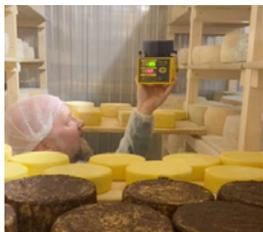
Рис. 2. Отбор проб воздуха в камере созревания сыра перед установкой приборов «ТИОКРАФТ»
