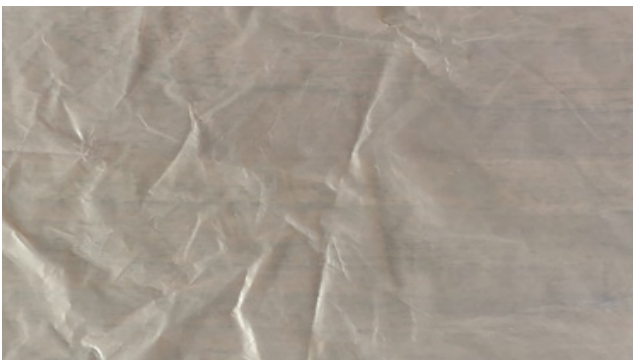
Рисунок 2. Внешний вид пленки из биоразлагаемого материала на основе PLA/PBAT
