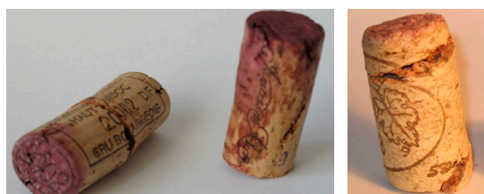
Рисунок 14. Результат несоответствия пробок показателям влажности и кажущейся плотности Figure 14. Corks with bad moisture and apparent density indicators
