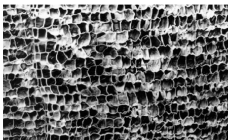
Рисунок 4. Сканирующая электронная микроскопия поперечного сечения пробки Quercus suber
